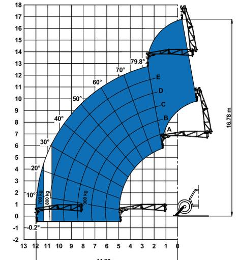
Mit 4 to Hydraulikwinde mit Abstützungen
